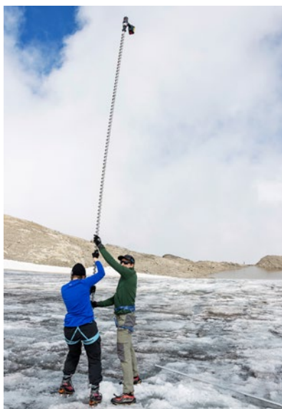
Les chercheurs ressortent le foret du trou qu'ils viennent de percer. Ils y réenfonceront la tige de mesure (à dr., au sol) à quatre mètres de profondeur dans la glace.
